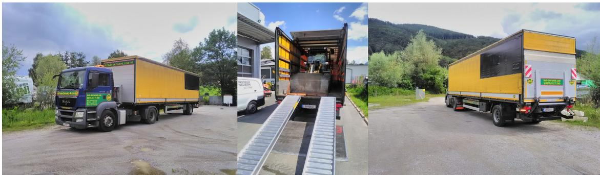
Be- und Entladung wird durch Ladebordwand (2000 kg), Rampen (Baumaschinen), Stapler, Baukran (Dach lässt sich komplett öffnen) oder über den schon bekannten, bei Bedarf mitgeführten Raupentransporter Mammut (1600 kg Tragkraft), geeignet auch für Quertransporte in Tiefgaragen und auf unbefestigten Böden, durchgeführt.
